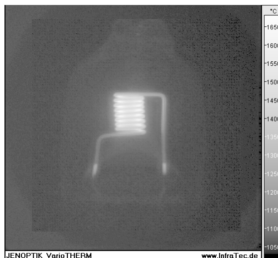
Halogénlámpa 50 mm-es teleoptikával, közgyűrűvel, többrétegű üvegen-keresztüli szűrővel készült hőképe [forrás: Infratec]
