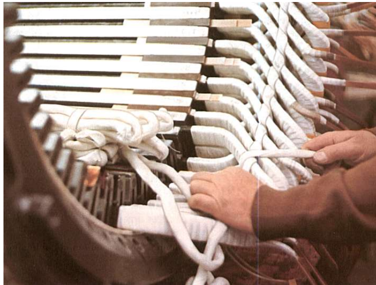
Nagyfeszültségű aszinkron villanymotor állórésze [Forrás: Lloyds - Dynamowerke, Bremen]
