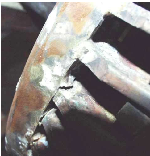
Példák forgórészrúd törésekre [forrás: CSi, DDC]
