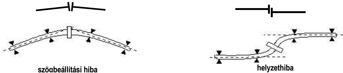
Két alapvető tengelybeállítási hibát különböztetünk meg egymástól [forrás: VMI]
